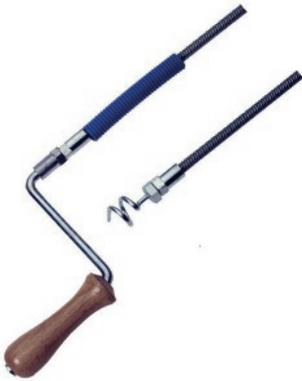
Mehrdrätig gewickelte Rohrreinigungswelle mit Seele, auswechselbarer Kralle und Kurbel. Verlängerbar, mit Kupplung 1/2" Ww.
