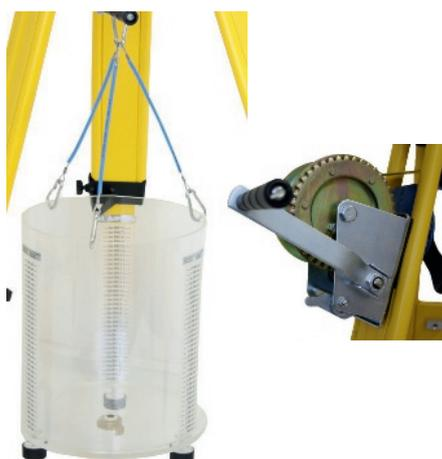
Zur Aufrechterhaltung der Wassersäule bei einer Dichtheitsprüfung mit Wasser kann das Stativ mit nachfolgendem Zubehör erweitert werden. Siehe auch S. 17
